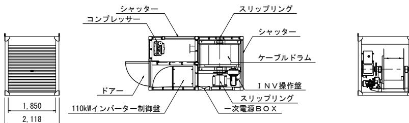
動力ケーブル長さ 160m 輸送時重量 4,800kg 使用発電機 220kVA
